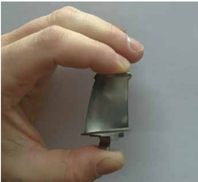
Turbinenschaufel eines Flugzeugtriebwerks mit einer Größe von 50 mm
